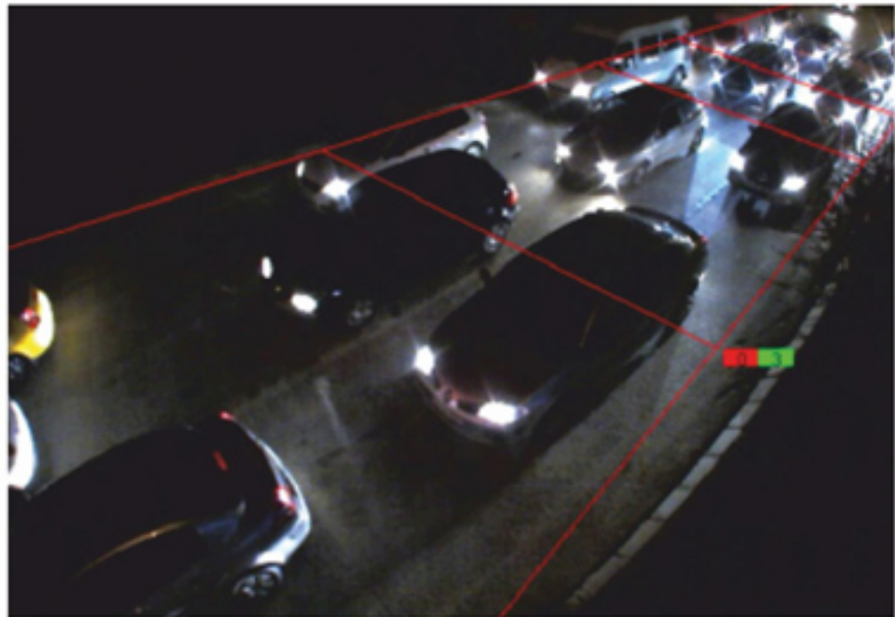
Şekil 5. Araç sayım modülü ile gece görüntülerinde sayım işlemi
